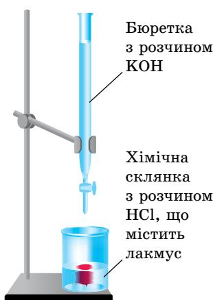
**Рис. 48.** Прилад для проведення реакції нейтралізації
